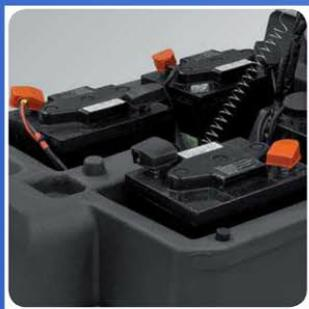
EL TANQUE DE AGUA DEL DETERGENTE SIRVE COMO COMPARTIMENTO PARA LAS BATERÍAS, DEJANDO UNA GRAN CAPACIDAD DE ESPACIO PARA LAS BATERÍAS, ASÍ PODER TENER MAYOR TIEMPO DE TRABAJO CONTÍNUO. CON UNOS TANQUES DE POLIETILENO CAPACES DE RESISTIR ÁCIDOS Y GOLPES, Y CON SU GRAN CAPACIDAD (110 LITROS) EVITAMOS EL CONTÍNUO LLENADO DE LOS TANQUES.
